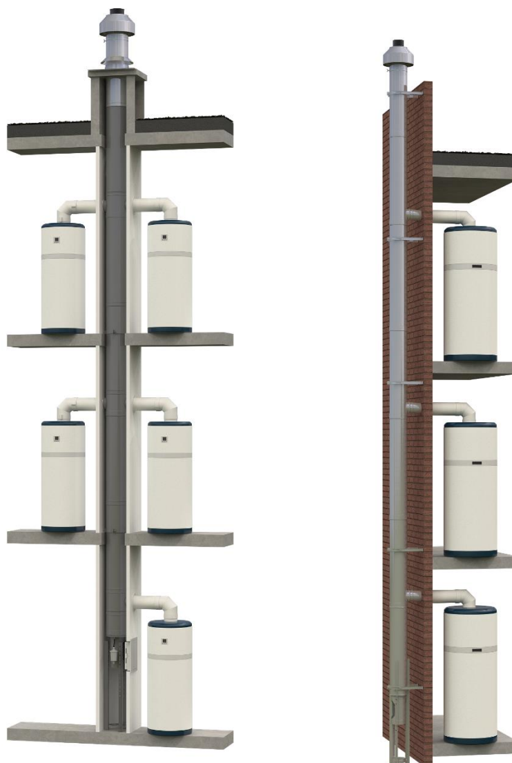
Installation dans la gaine technique (appareils installés dans le logement)
