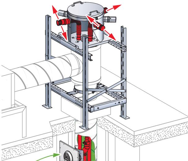
**Le terminal est installé en toiture, en tête de chaque colonne raccordée aux appareils VMC-Gaz. Entièrement en acier inoxydable, il :**
