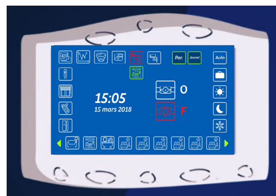
Alerte fuite d'eau
