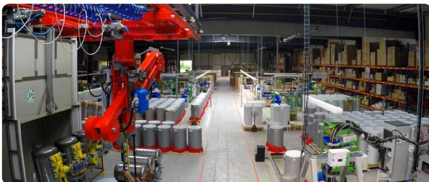
L'extension de notre site accueille 12 000 m<sup>2</sup> de nouveaux moyens de production robotisés pour la fabrication des pompes à chaleur et des chauffe-eau thermodynamiques.
