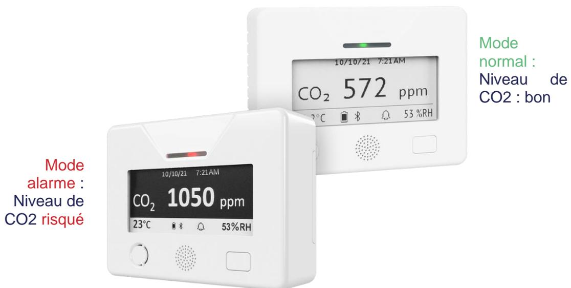
Lorsque la concentration de CO<sub>2</sub> dépasse le seuil d'alarme, la couleur de l'écran e-paper est inversé pour vous inviter, avec un indicateur sonore (les deux paramètres sont configurables)
