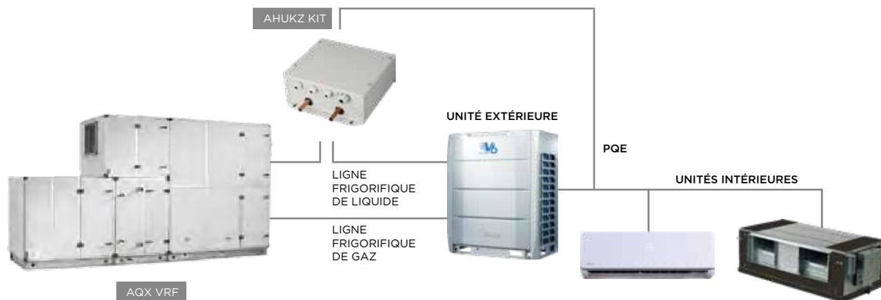
**Puissance frigorifique :** Puissance paramétrables à l'aide d'un commutateur DIP sur la carte électronique. Conditions nominales : Réfrig. 27 °C BS/19 °C BH intérieur, 35 °C BS extérieur. Chauff. 20 °C BS intérieur, 7 °C BS/6 °C BH extérieur. Long. de la tuyauterie 7,5 m. Hauteur 0 m.
