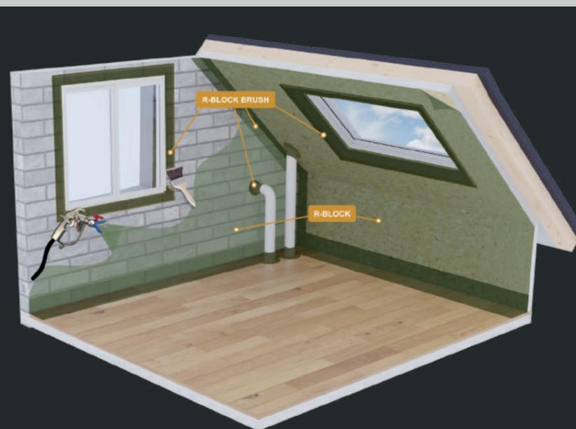
RBLOCK s'applique facilement à l'aide d'une pompe ou pistolet airless sur tous supports du bâtiment. RBLOCK BRUSH est lui fibré afin de combler les éventuelles fissures et jointures. Il s'applique à l'aide d'un pinceau ou de notre pistolet à air comprimé KOGUN. Ces produits sont de couleur verte ou blanche afin d'allier technicité et finition pour les opérations de rénovation.
