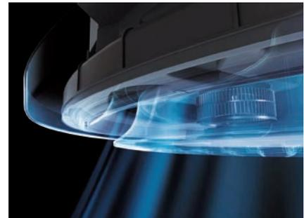
Grâce à la présence de ventilateurs auxiliaires (Booster Fans), la cassette 360 souffle l'air en parallèle du plafond (effet Coanda). Ceci minimise ainsi la sensation de courant d'air et favorise le brassage d'air par convection naturelle.
